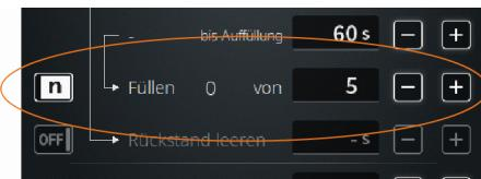
Im Beispiel: fünfmal Befüllen, anschließend läuft optional zusätzliche Verdampfungszeit ab. Hierdurch kann eine gewünschte Konzentration erreicht werden!
