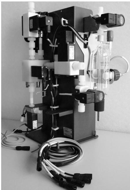
Un système Hei-VOLUME Distimatic Pro & Hei-VAP Expert/Ultimate se compose de modules prémontés (condenseur, matrice à soupapes).
