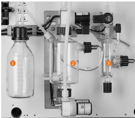
Der Einsatz des Automatikmoduls Hei-VOLUME Distimatic Pro mit einem Rotationsverdampfer Typ Hei-VAP Industrial erfordert einen speziellen Glassatz bestehend aus Woulfescher Flasche [1], Kollektor- [2] und Vorlagesensorgefäß [3].
