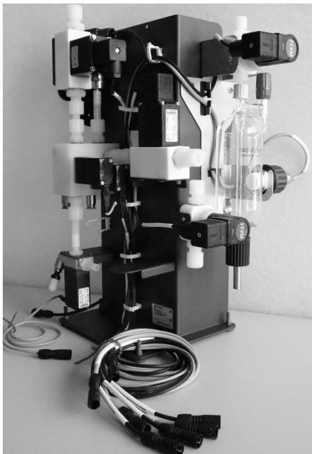
Ein System Hei-VOLUME Distimatic Pro & Hei-VAP Expert/Ultimate besteht aus vormontierten Baugruppen (Glaskühler, Ventilmatrix).
