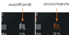
Dès que le ruban chauffant a été correctement détecté, une icône correspondante s'affiche sur l'interface du logiciel. Touchez l'icône correspondante pour mettre en marche/arrêter le ruban chauffant :
