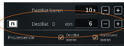
Im Beispiel: sechsmal [Destillat leeren], anschließend läuft optional die zusätzliche Verdampfungszeit ab. Hierdurch kann eine gewünschte Konzentration erreicht werden!
