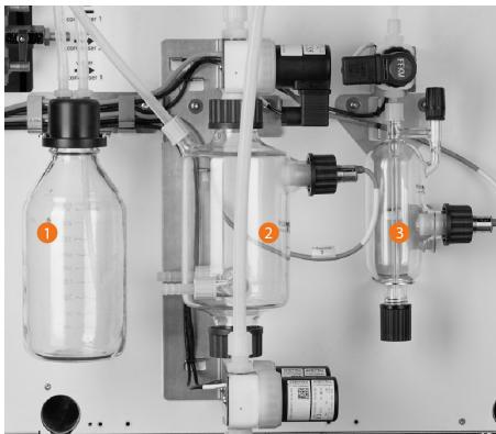
L'utilisation du module automatique Hei-VOLUME Distimatic Pro avec un évaporateur rotatif de type Hei-VAP nécessite une verrerie spéciale composée d'un flacon de Woulff [1], d'un récipient collecteur [2] et d'un récipient à capteur [3].
