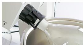
EASY CLIP geschlossen, Kolben gesichert
