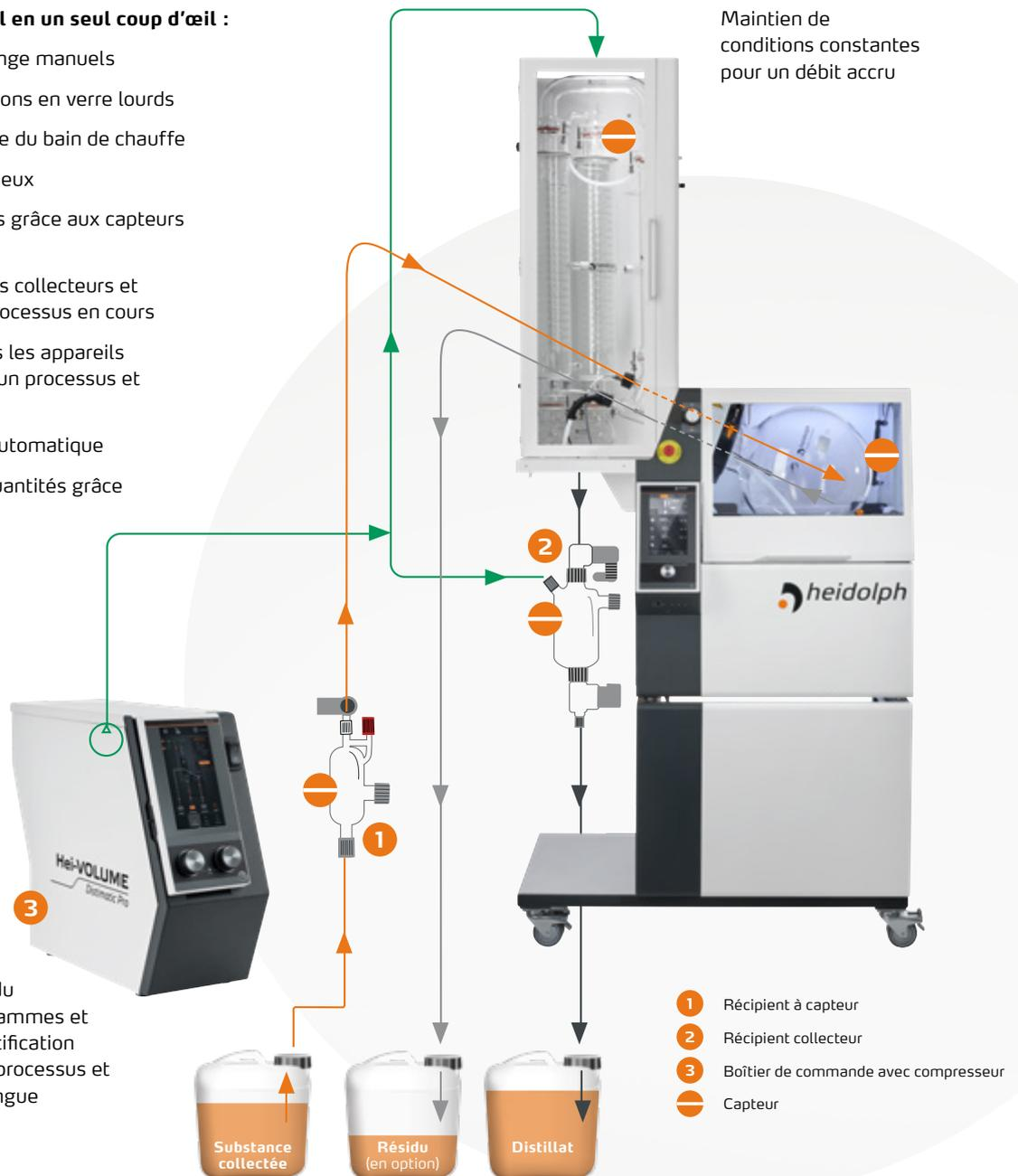
Affichage du déroulement du processus avec des pictogrammes et des couleurs pour une identification claire de la progression du processus et interface utilisateur multilingue
