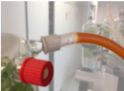
Abb. 3: Algenbildung in den Kühlwendeln und Kühlwasserschläuchen
