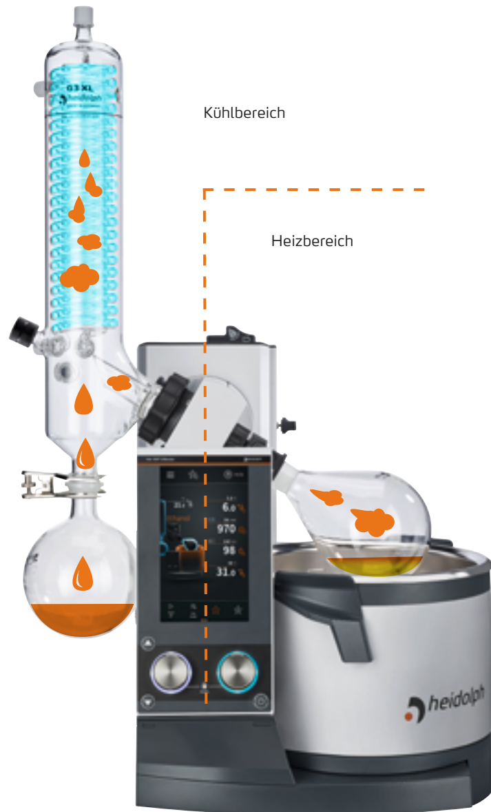
Abb. 1: Verdampfungsprozess am Rotationsverdampfer
