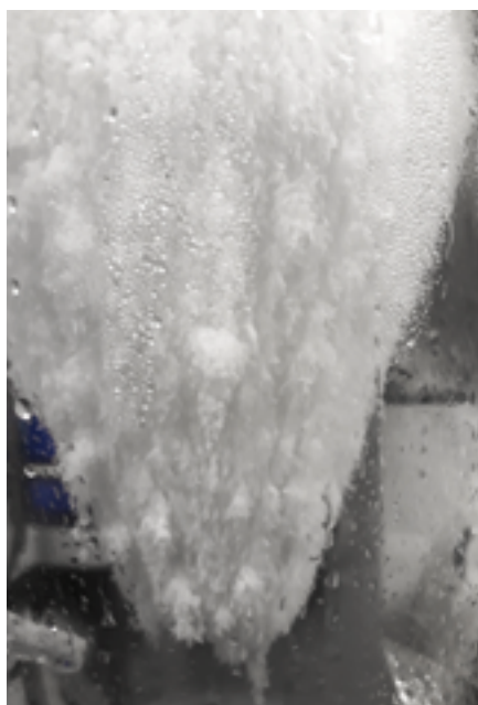
Abb. 2: Eiskristalle aus Luftfeuchtigkeit bilden sich im Trockeneiskühler zwischen den Anwendungen
