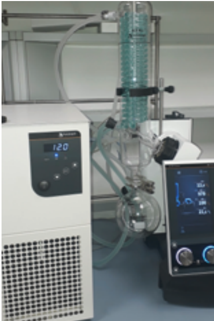
Abb. 4: Rotationsverdampfer-System mit Umlaufkühler
