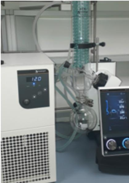
Fig. 4 : système d'évaporateur rotatif avec refroidisseur à recirculation
