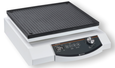
Abb. 1: Beispiel eines Orbitalschüttlers: Unimax 1010 von Heidolph Instruments
