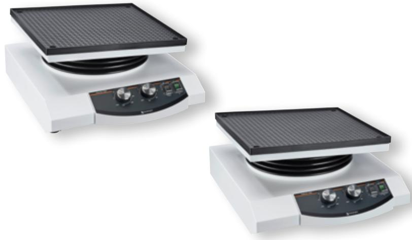
Fig. 4 : Exemples d'agitateur 2D et 3D : Duomax 1030 (agitateur basculant) et Polymax 1040 (agitateur oscillant) de Heidolph Instruments
