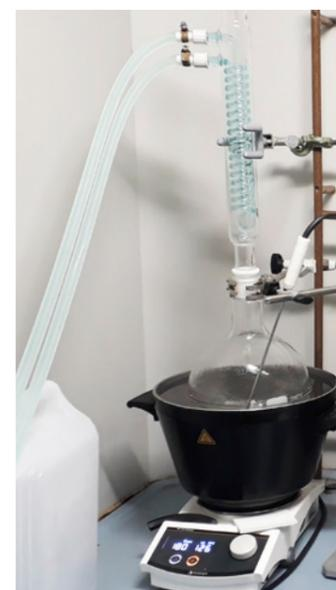
Ill. 1 Chauffage à reflux avec condenseur à eau
