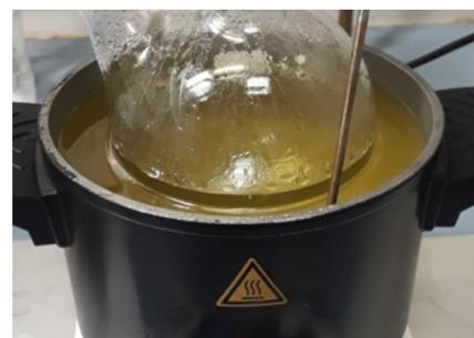
Un contrôle précis de la température de la réaction est seulement possible en utilisant une sonde
